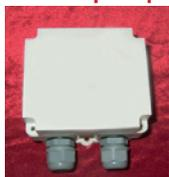
Устройство соединительное УСБ «СЕВЕР» предназначено для коммутации электрических соединений и шлейфов пожарной или охранно-пожарной сигнализации, линий связи и т.д. Корпус изделия оборудован герметичными кабельными вводами для подведения проводников диаметром от 6 до 14 мм (от 6 до 11 мм; от 9 до 14 мм). Внутри корпуса изделия установлена печатная плата, с винтовыми клеммниками. Степень защиты от внешних воздействий IP55 по ГОСТ 14254-96.
