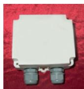
Устройство соединительное УСБ-Ех «СЕВЕР» предназначено для коммутации электрических соединений и шлейфов пожарной или охранно-пожарной сигнализации, линий связи и т.д. Корпус изделия оборудован герметичными кабельными вводами для подведения проводников диаметром от 6 до 14 мм от 6 до 11 мм; от 9 до 14 мм). Внутри корпуса изделия установлена печатная плата, с винтовыми клеммниками. Маркировка взрывозащиты 0ExialICT6. Степень защиты от внешних воздействий IP55 по ГОСТ 14254-96.
